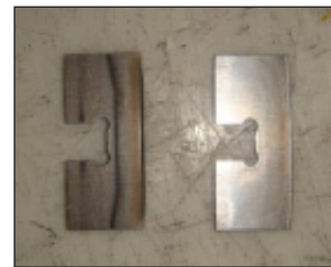
(左) 過度の/早期のベアリング摩耗 (右) 実際の様々な腐食部分の例
