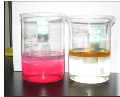
HFC作動油は水と完全に混ざります。（左のビーカー）水から有機物を取り除くために、CODを懸念することに加えて、大規模な化学的な処理工程を必要とします。HFD-U作動油は水と容易に分離します。（右のビーカー）
